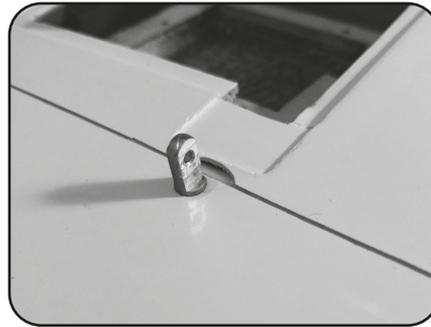
**02** Den Servohebel für das Querruderservo auf 10mm ablängen (siehe Abb.) und das Loch zum Anschluss der Gestänge auf 1.5mm aufbohren. Das Servo in Mittelstellung bringen und den Servohebel rechtwinklig auf das Servo stecken und mit einer Schraube sichern.
