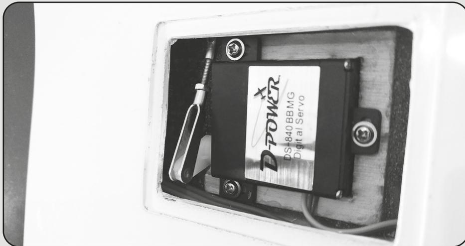
**12** Die Servoschachtabdeckung in der Aussparung der Tragfläche positionieren und z.B. mit Klebeband befestigen. **HINWEIS: Die Servoschachtabdeckung so positionieren, dass der Servohebel und das Gestänge nicht die Abdeckung berühren.**
