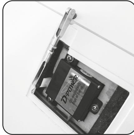
**06** Die Servoschachtabdeckung in der Aussparung der Tragfläche positionieren und z.B. mit Klebeband befestigen. **HINWEIS: Die Servoschachtabdeckung so positionieren, dass der Servohebel und das Gestänge nicht die Abdeckung berühren.**
