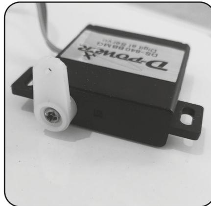
**03** Das Servoanschlusskabel mit dem bereits in der Tragfläche eingezogenen Verlängerungskabel verbinden und das Kabel im Schacht verstauen. **Hinweis: Die Servosteckerverbindung gegen lösen mit z.B. Klebeband sichern.**
