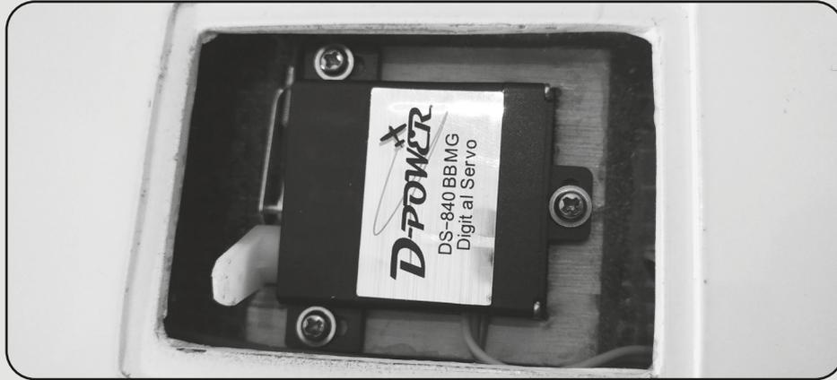
**11** Das fertige Gestänge am Servo und am Ruderhorn der Wölbklappe einklipsen. Das Gestänge durch drehen justieren, sodass die Wölbklappe genau mittig steht. Gabelköpfe und Muttern mit Schraubensicherungslack gegen verdrehen sichern.
