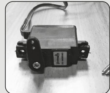
**18** Das Servo wie abgebildet mit Schrauben im Servo / RC Brettchen befestigen.
