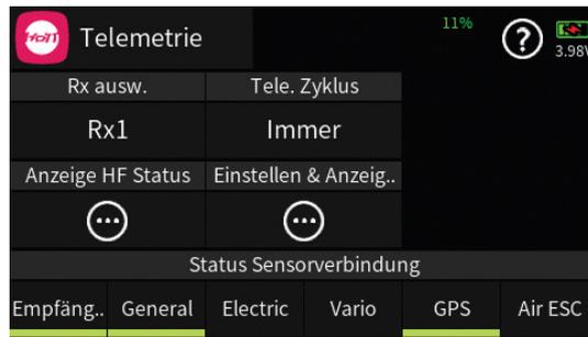
Um zu den Telemetrie-Displays dieser Geräte zu gelangen, ist im Display „Einstellen & Anzeigen“ das mit „Empfänger“ beschriftete Wertefeld rechts unten anzutippen ...
