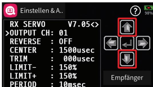
Menüzeilen, in denen Parameter geändert werden können, sind durch eine vorangestellte spitze Klammer (>) markiert. Durch Antippen der unteren oder oberen Taste wird dieser „>“-Zeiger eine Zeile abwärts oder aufwärts bewegt.
