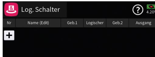
... können zwei beliebige Bedienelement des Senders, egal ob Steuerknüppel, Schalter, Dreh- oder sonstiger Geber, durch simples Bewegen des gewünschten Elementes oder Umlegen eines Schalters dem gewählten Eingang zugewiesen und mit Hilfe einer der in der Spalte „Logischer“ ausgewählten Logik-Schaltung miteinander verknüpft werden. Das jeweilige Ergebnis aus Geberposition und Logik-Schaltung wird rechts, in der Spalte „Ausgang“, angezeigt.
