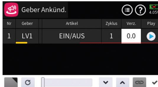
Wie zuvor unter „Zyklus“ beschrieben, ist mit dem Schieber oder den Tasten eine Zeitspanne zwischen 0.0 und 10.0 Sekunden als Pause zwischen den Zyklen einstellbar.
