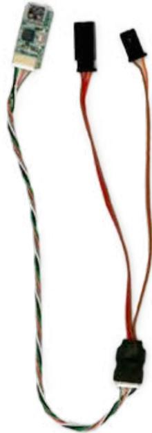
Firmware Updates des **Graupner-HoTT 33601 Vario Moduls** werden mit Hilfe eines PCs mit Windows 7 oder höher durchgeführt. Zur Verbindung des Moduls mit dem PC wird darüber hinaus die separat erhältliche USB Schnittstelle **Best.-Nr. 7168.6** und das Adapterkabel **Best.-Nr. 7168.6S** benötigt.
