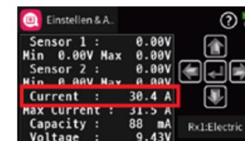
Unabhängig davon, aus welchem Grund auch immer die Stromregelung aktiviert werden soll, egal ob z. B. wegen eines maximal nur mit weniger als 150A belastbaren Motors oder Motorstellers oder aus Rücksicht auf das nur maximal 150A vertragende Electric Air-Modul, das Vorgehen ist in beiden Fällen das Gleiche: Es muss bekannt sein, an welcher Servoposition der limitierende Wert überschritten wird.
