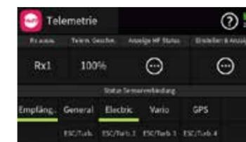
Sobald sowohl der Sender als auch der Empfänger einschließlich des daran angeschlossenem EAM-Moduls betriebsbereit sind, sollte, abhängig vom jeweils genutzten Sendertyp, in dessen Telemetrie-Menü zusätzlich zum Empfänger zumindest das „Electric“-Modul sichtbar oder nach Art des Senders ansprechbar sein. In dieser Anleitung illustriert anhand von Screenshots des Displays der Sender mz-16/32 HoTT bzw. mc-32ex HoTT.
