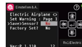
Um geänderte Einstellungen abschließend zu speichern, ist mit den Methoden des jeweiligen Senders das Display „GPS Sensor / Page 1“ und dann der Menüpunkt „Save Sensor“ anzusteuern und zu aktivieren.
