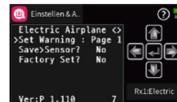
Die zweite Displayseite–die mittlere der weiter oben abgebildeten drei–fasst unter dem Oberbegriff „Set Warning“ 21 weitere Unterseiten zusammen, auf welchen die standardmäßigen Warnparameter individualisiert und abschließend auf der „Page 1“ gesichert oder ggf. wieder verworfen werden oder gar das Modul auf die Werkseinstellungen zurück gesetzt wird.
