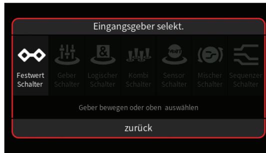
Völlig unabhängig von diesen Symbolen wird jedes beliebige Bedienelement des Senders, egal ob Steuerknüppel, Schalter, Dreh- oder sonstiger Geber, durch simples Bewegen des gewünschten Elementes oder Umliegen eines Schalters dem gewählten Eingang zugewiesen.
