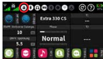
In der Grundanzeige des Senders wird die Eingabesperre des Bildschirms durch ein ca. eine Sekunde andauerndes gleichzeitiges Drücken der linken und rechten unteren Auswahltaste aktiviert.
