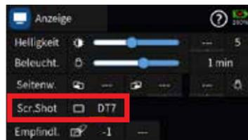
Diese, im Menü „Anzeige“ des „blauen“ System-Menüs zu findende Option ist ein praktisches Hilfsmittel nicht nur bei der Erstellung von Display-Abbildungen für diese Anleitung, sondern beispielsweise auch zur Erstellung von Dokumentationen zu Modelleinstellungen, zur Weitergabe von Einstellungen an andere Modellpiloten usw.
