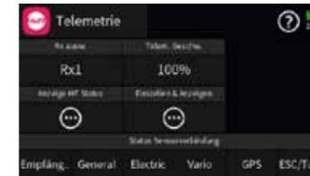
Im Untermenü „Telemetrie“ des „roten“ Spezial-Menüs des Senders **Graupner mc-32ex HoTT** stehen insgesamt vier Optionen zur Auswahl.
