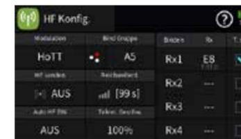
Dieses „Binding“ oder „Binden“ eines Empfängers erfolgt beim Sender **Graupner mc-32ex HoTT** standardmäßig immer im Rahmen einer so genannten Bindungsgruppe, wobei beim Binden eines ungebundenen Modellspeichers automatisch immer die nächste freie Gruppe vorgeschlagen wird. Solange dieser Vorschlag stets übernommen wird ist sichergestellt, dass sich jeder Modellspeicher in einer eigenen Bindungsgruppe befindet. Im Regelfall also eine **modellspezifische** Bindung erfolgt.
