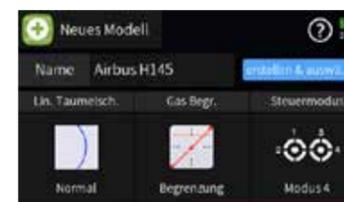
3. Ist der gewünschte Modelltyp fertig zusammengestellt und mit dem passenden Modellnamen versehen, ist zum Abschließen des Vorganges der blau hinterlegte Button „erstellen & auswählen“ anzutippen. Der Sender speichert die Änderungen ab und startet mit dem eben erstellten Modell neu.
