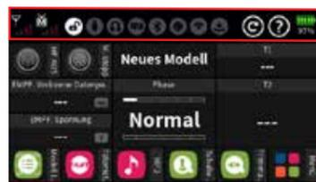
Die Bedienung des Displays erfolgt, analog zur Bedienung anderer berührungssensitiver Displays, durch Antippen der gewünschten Option mit der Fingerspitze oder mit einem für kapazitive Displays geeigneten Stift. Ausgenommen davon sind nur die in der Abbildung links rot umrandeten Statusanzeigen der sechs frei konfigurierbaren Hauptdisplays.
