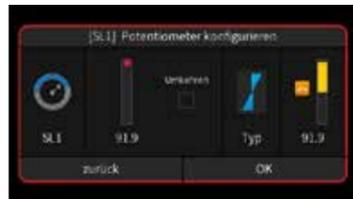
In diesem Menü können Bedienelemente wie z. B. Schalter, Schieberegler und Tastschalter den Kanälen zugewiesen, bearbeitet und/oder entfernt werden.
