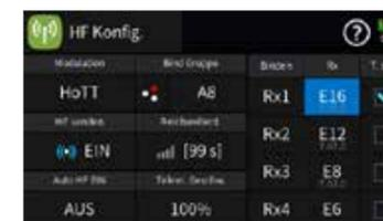
Bis zu vier Empfänger können im Untermenü „HF Konfig.“ des Basis-Menüs an einen Modellspeicher gebunden werden. Eine Telemetrie-Verbindung kann jedoch immer nur zu einem dieser maximal vier Empfänger aufgebaut werden. Standardmäßig ist das immer der zuletzt gebundene. An diesem, üblicherweise als Hauptempfänger bezeichneten, Empfänger sind ggf. auch alle Sensoren anzuschließen da normalerweise nur der Rückkanal des Hauptempfängers vom Sender ausgewertet wird. Dieser ist im
