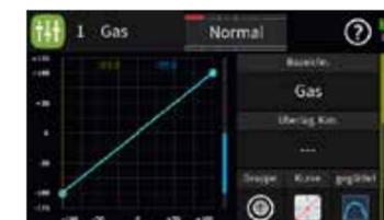
Die waagrechte Kennlinie kann nur vertikal verschoben und somit beispielsweise als Basis von Drehzahlvorgaben für Drehzahlregler genutzt werden.
