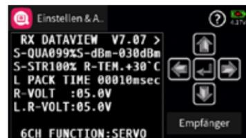
Antippen des Symbols öffnet das Display „Einstellen & Anzeigen“. Ist in der untersten Zeile des Displays keines der genannten Geräte mit einem grünen Balken unterlegt und bleibt nach dem Antippen des Symbols das Anzeigefenster leer, besteht keine Verbindung zu einem entsprechenden Gerät. Schalten Sie also ggf. Ihre Empfangsanlage ein oder auf den richtigen Empfänger oder Gerät um.
