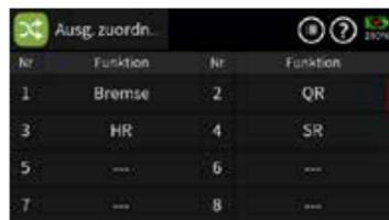
Da die Übertragung der Steuerkanäle an den Empfänger senderseitig unter Berücksichtigung der modellspezifischen Anforderungen und verwendeten Kanäle optimiert wird, müssen alle benötigten Steuerkanäle/Ausgänge im Menü „Ausgang zuordnen“ des Basis-Menüs entsprechend zugeordnet sein.
