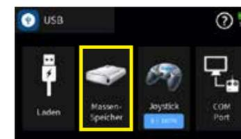
Das Sichern wie auch der Austausch von Modelldaten zwischen kompatiblen Sendern wird über die stirnseitige USB C-Buchse und der senderseitigen Einstellung „Massenspeicher“ mit Hilfe eines Laptop- oder PC-üblichen Dateieexplorers oder -managers durchgeführt. Zu finden sind die einzelnen Modellspeicher beim Sender **mc-32ex HoTT** unter dem Pfad \\mc-32\Model\mc-32.
