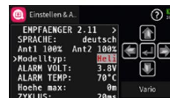
Nach erfolgreicher Vorbereitung des Senders und des Helikopters ist das Telemetrie-Menü des Senders entsprechend der jeweiligen Senderanleitung aufzurufen und im Empfänger-Menü der Modelltyp auf „Heli“ zu stellen, siehe Abbildung links.
