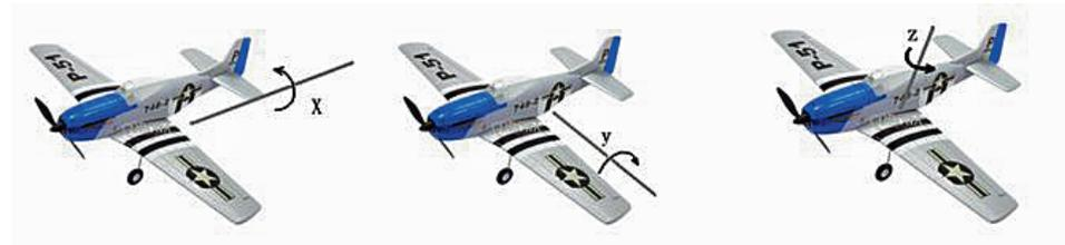
Wenn nötig, kann die Servo Richtung im Sender umgestellt werden (REV). Um die Kreiselwirkung zu ändern, muss das jeweilige Potentiometer in die entgegengesetzte Position gestellt werden.
