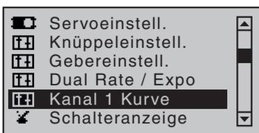
Dieses Menü ermöglicht eine Veränderung der Steuercharakteristik der Steuerfunktion 1. Die Steuerfunktion wirkt direkt auf das an Steuerkanal 1 angeschlossene Servo oder über beliebige Mischer auf mehrere Servos. Einstellungen in diesem Menü wirken bei einem Flächenmodell auf die Gas-/Brems-Steuerfunktion und bei einem Hubschrauber auf die Gas-/Pitch-Funktion.
